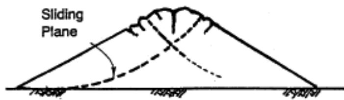
(d) Cracking and Sliding in Earth Dam
