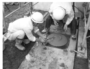
写真-5 スランプ試験
